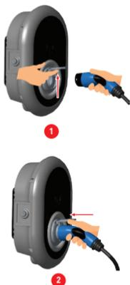
6- Schalten Sie die Ladestation ein. Das Kabel wird gesperrt und die Ladestation verhält sich wie ein Kabelmodell.
