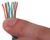
**7** - Führen Sie die abgeflachten, angeordneten Drähte vorsichtig in den Steckverbinder ein und drücken Sie diese durch, bis die Drahtenden aus den Stiften austreten.
